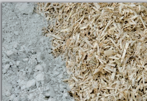
Chanvribat (chènevotte spécial bâtiment) + chaux aérienne Tradical PF 70 de BCB pour les applications bétons de chanvre.
